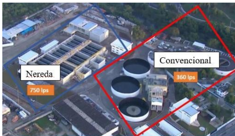
Figura 1. Comparação entre capacidade de vazão x área entre a Nereda e o Convencional. Fonte: BRK Ambiental.
