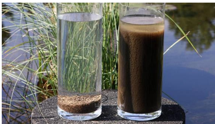
Figura 2. Comparação da sedimentação entre Nereda x Convencional respectivamente.
